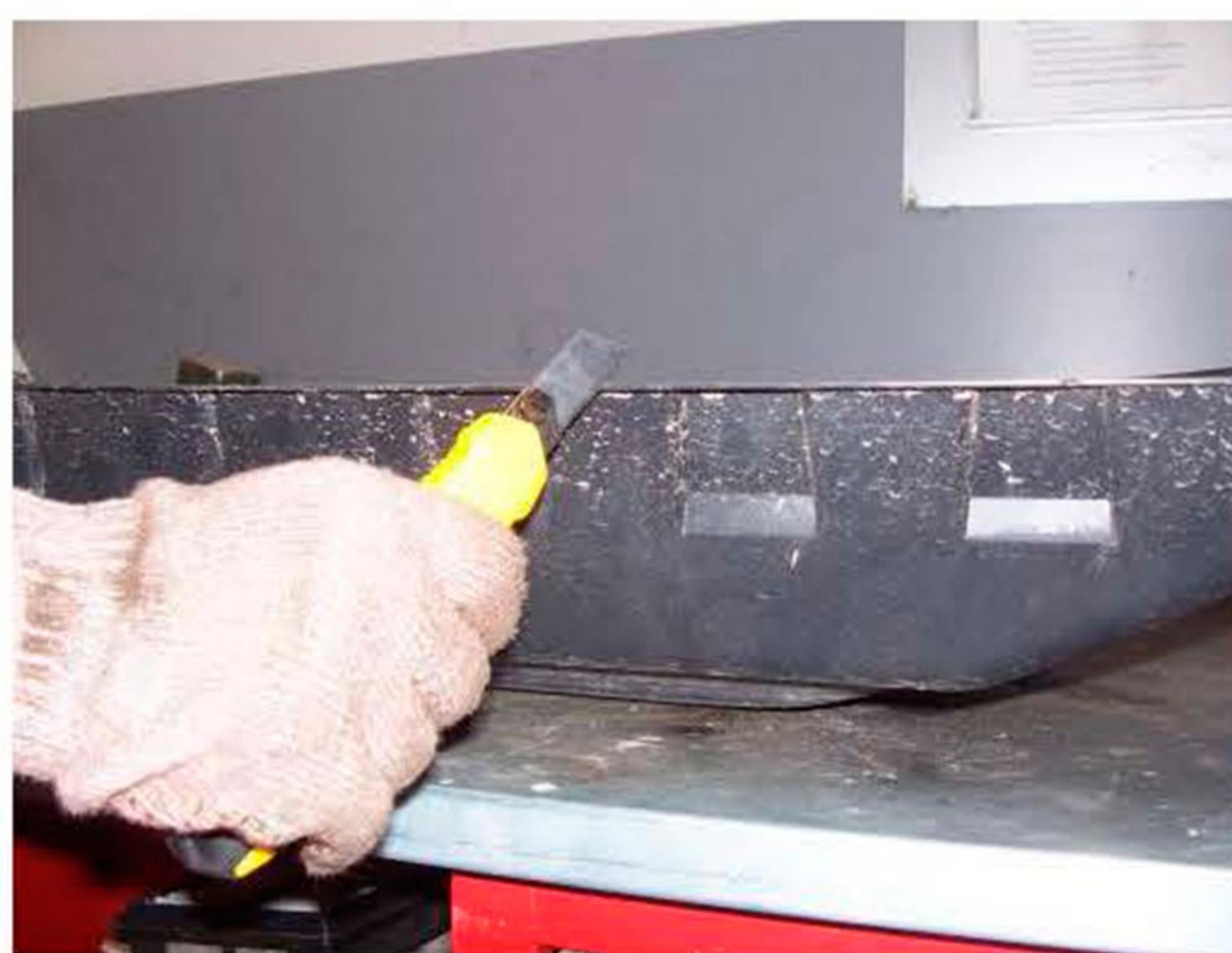
Рис.6 Пазы в пластиковом пыльнике
