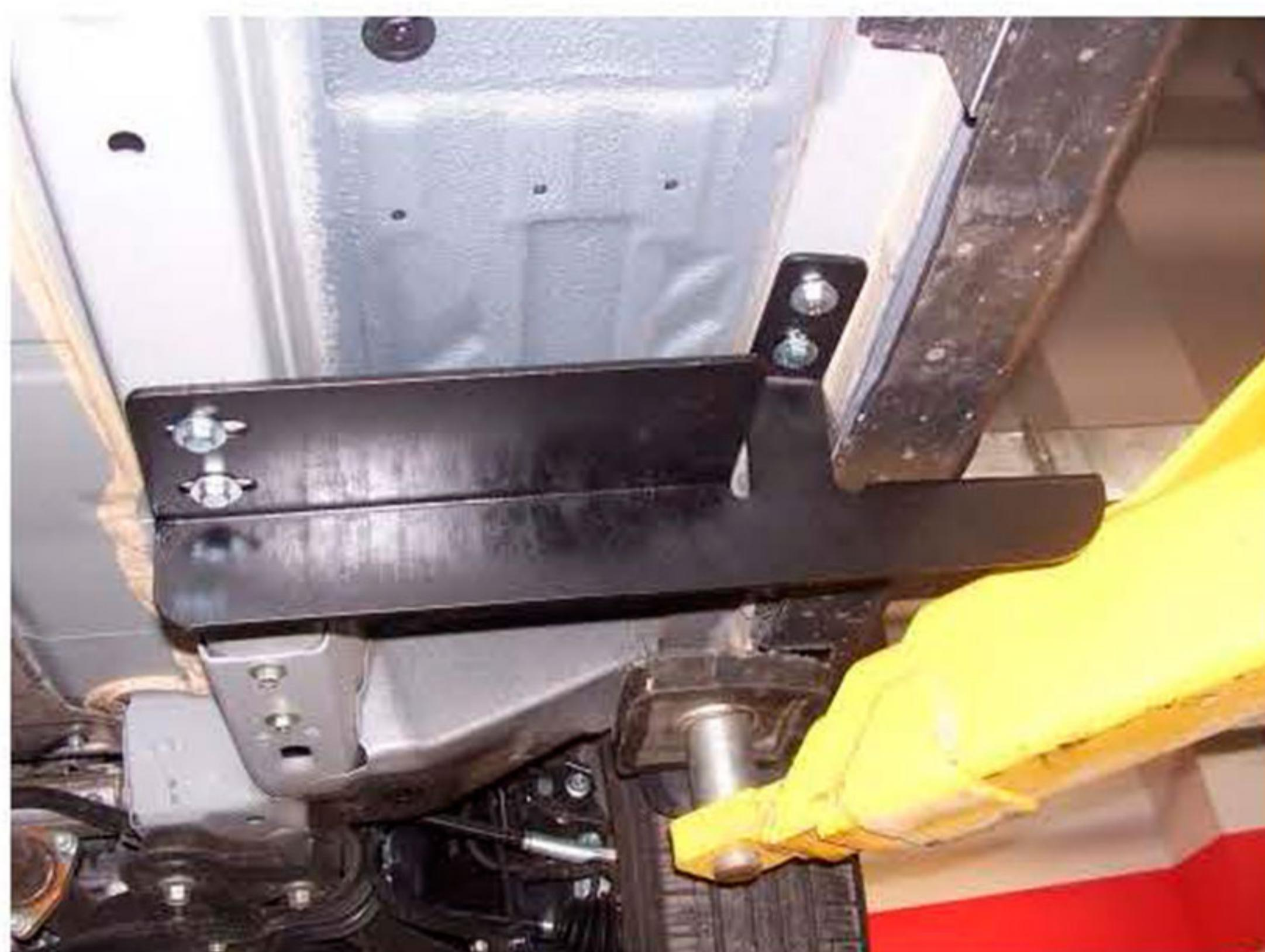
Рис.4 Установка переднего кронштейна
