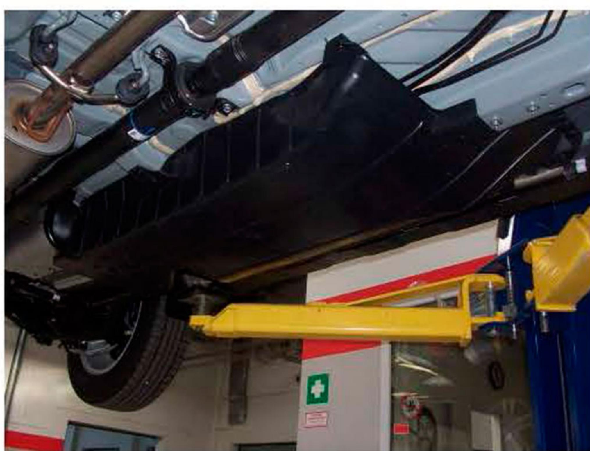
Рис.2 Пыльник автомобиля
