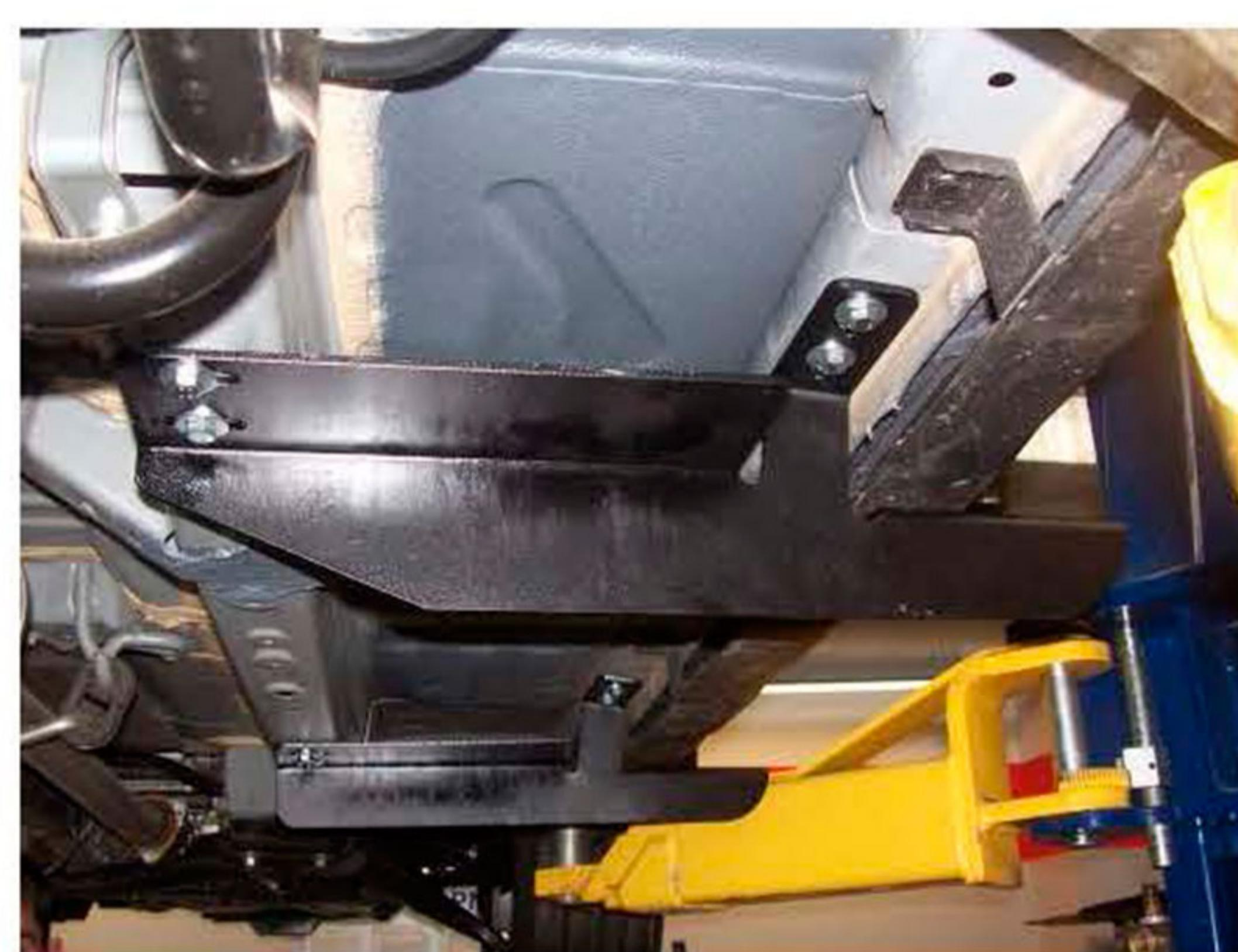
Рис.5 Установка заднего кронштейна
