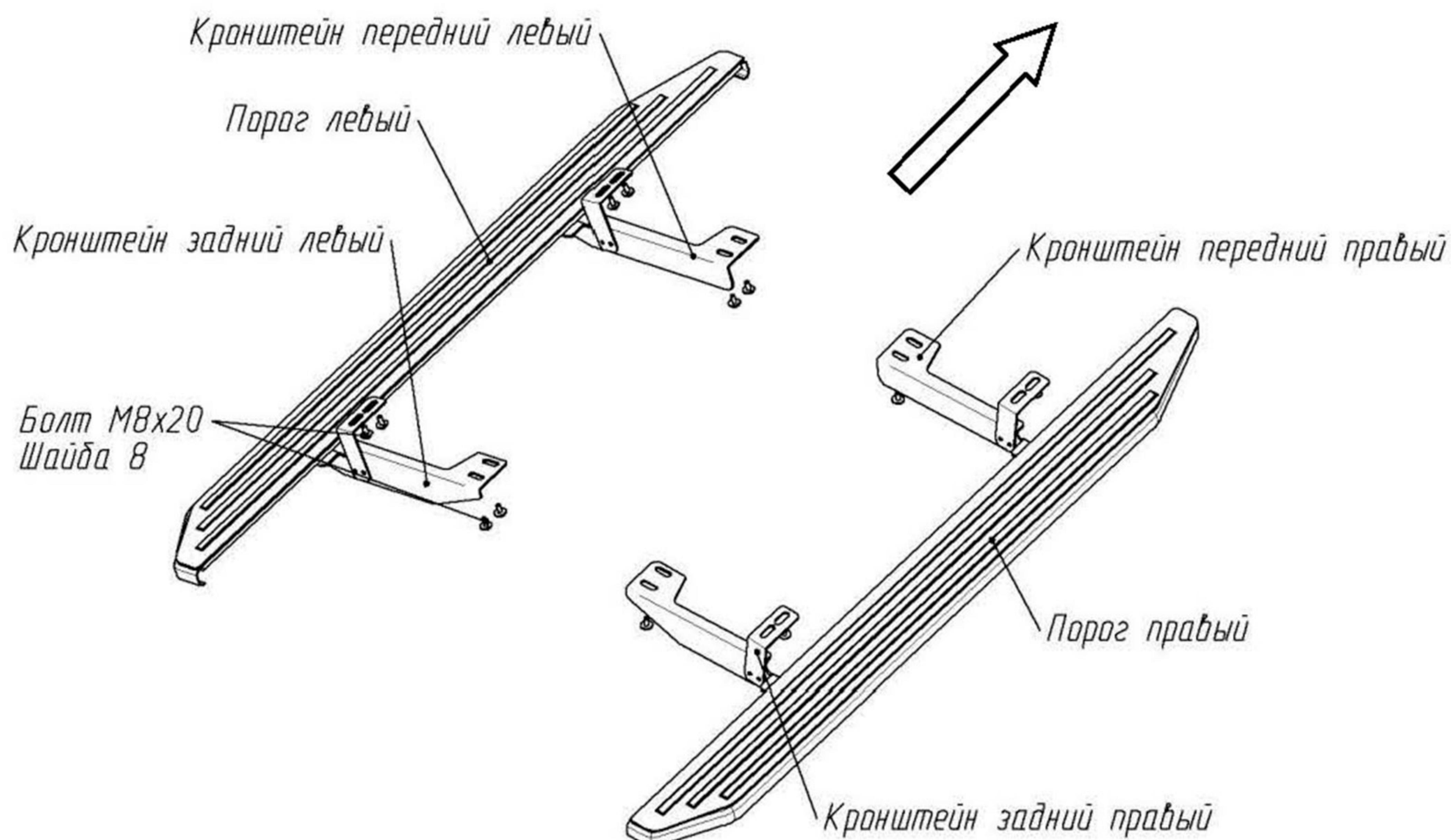
Рис. 1 Схема установки комплекта порогов
