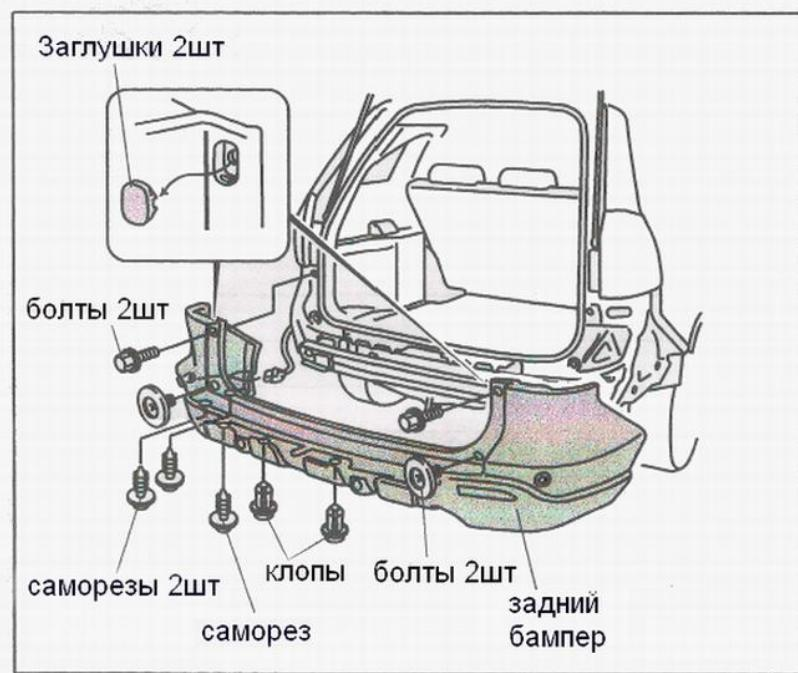
4. Снимите задний диффузор.
