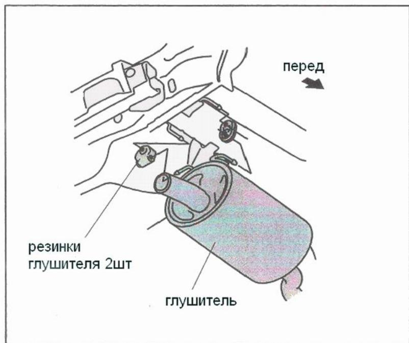
6. Устанавливаем резинки глушителя на правую лапу.
