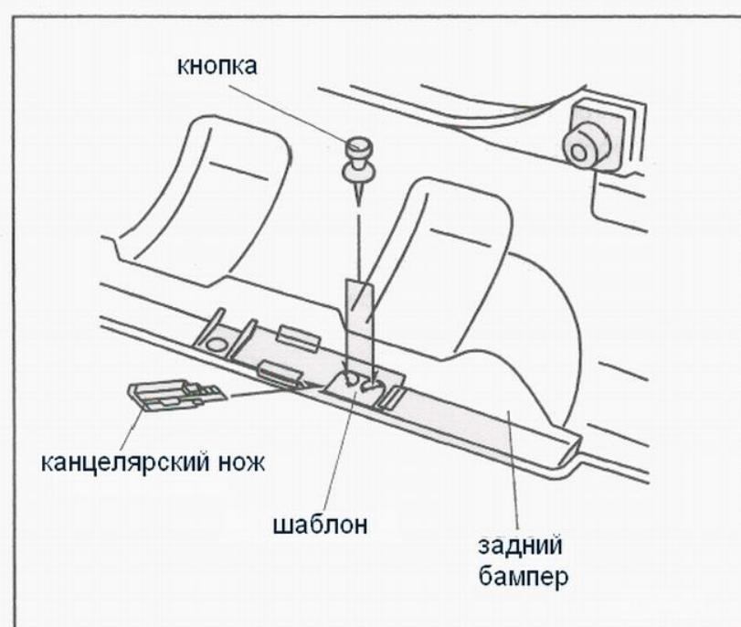
16. Сверлим разметку сначала диаметром 3мм, затем кольцом 30мм.
