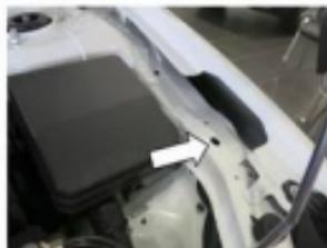
1. Завести под отверстие в кузове гайку закладную М8х50.
