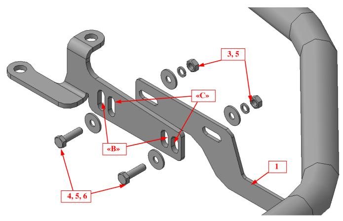
**Шаг 4** Установить защиту поз.1 на кронштейнѕ поз.2, закрепить крепежом поз.3, 4, 5 и 6.
