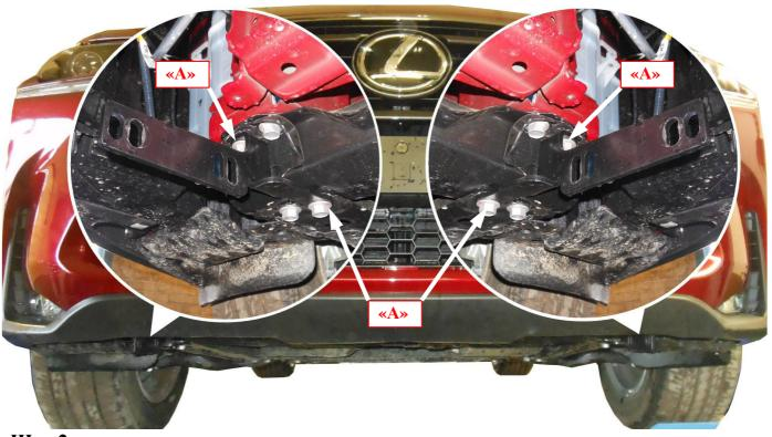
**Шаг 2** Отвернуть штатные болты «А» согласно рисунка. *Инструмент: Головка 19 с воротком.*
