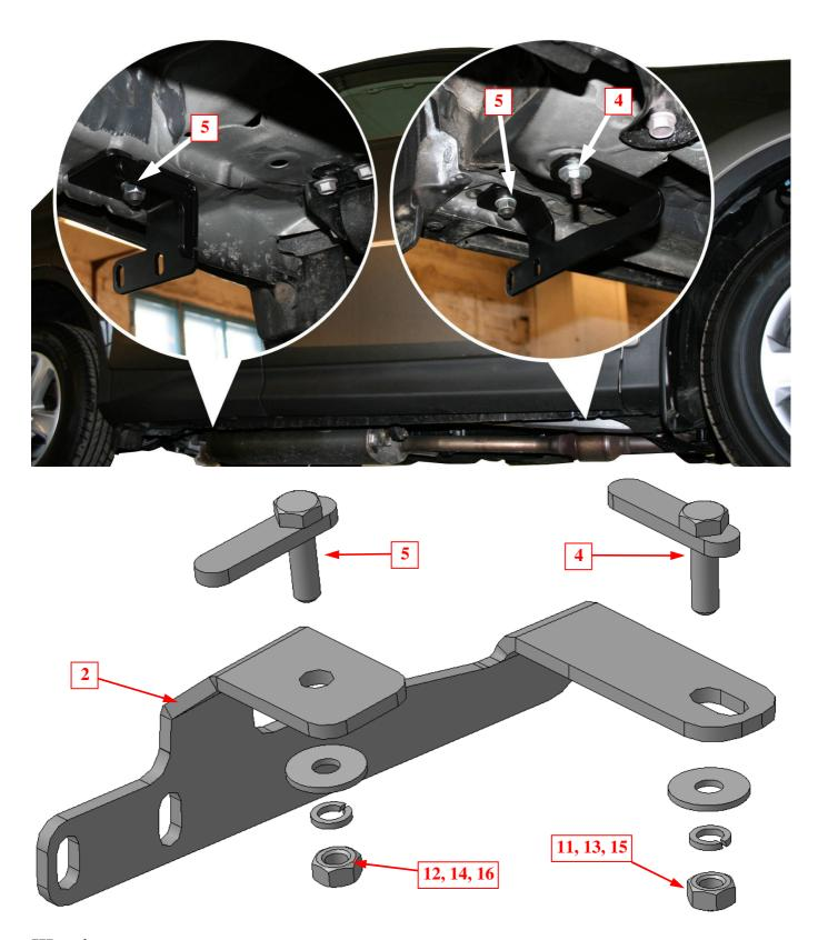
**Шаг 1** Установить закладные поз.4 и 5 в окна в передней части порогов автомобиля (справа и слева). Установить на закладные кронштейны поз.2, закрепить крепежом поз.11, 12, 13, 14, 15 и 16. *Инструмент: Головка 17, 19 с воротком*.
