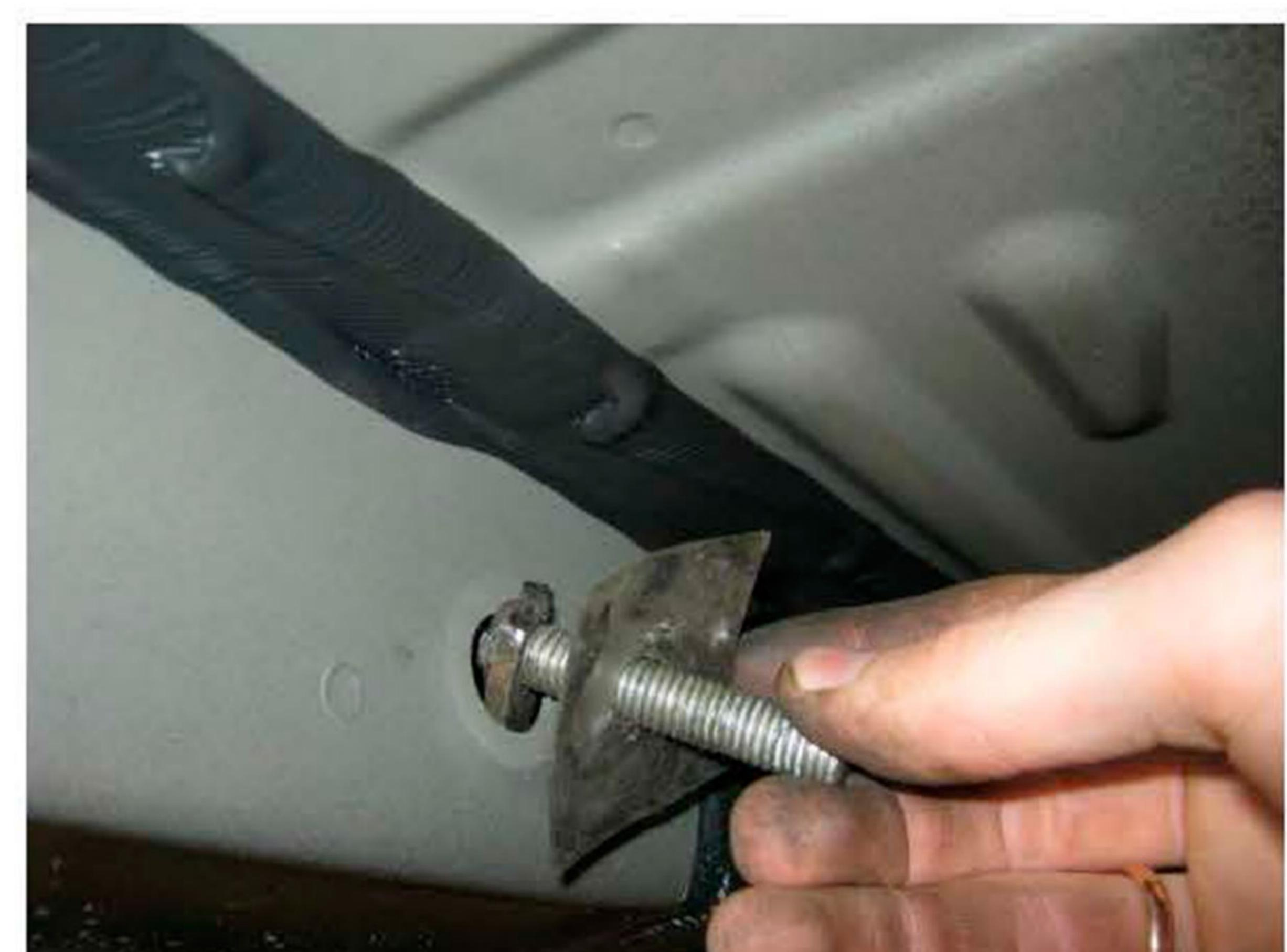
Рис.3 Установка шпильки закладной M10x48
