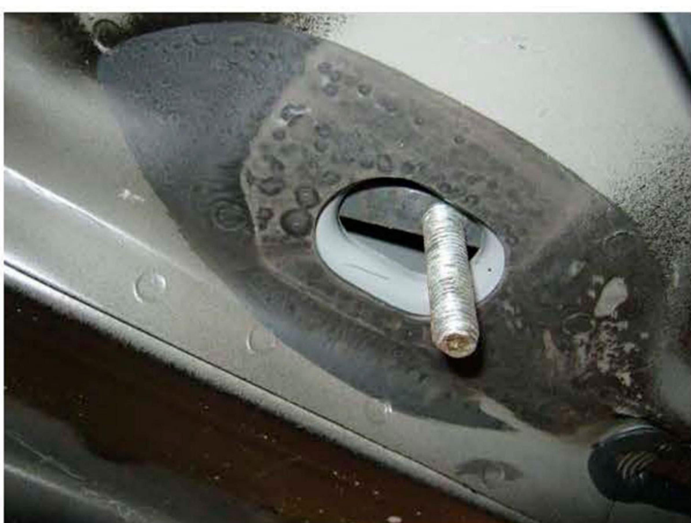
Рис.6 Установка шпильки закладной
