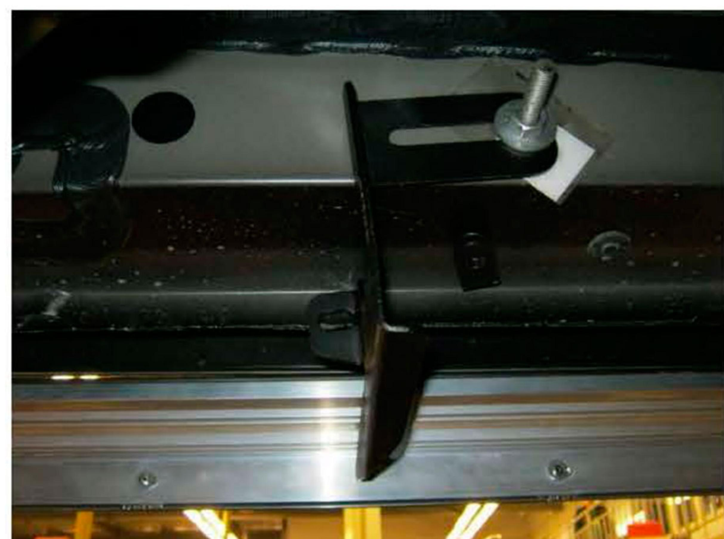
Рис.5 Установка среднего кронштейна
