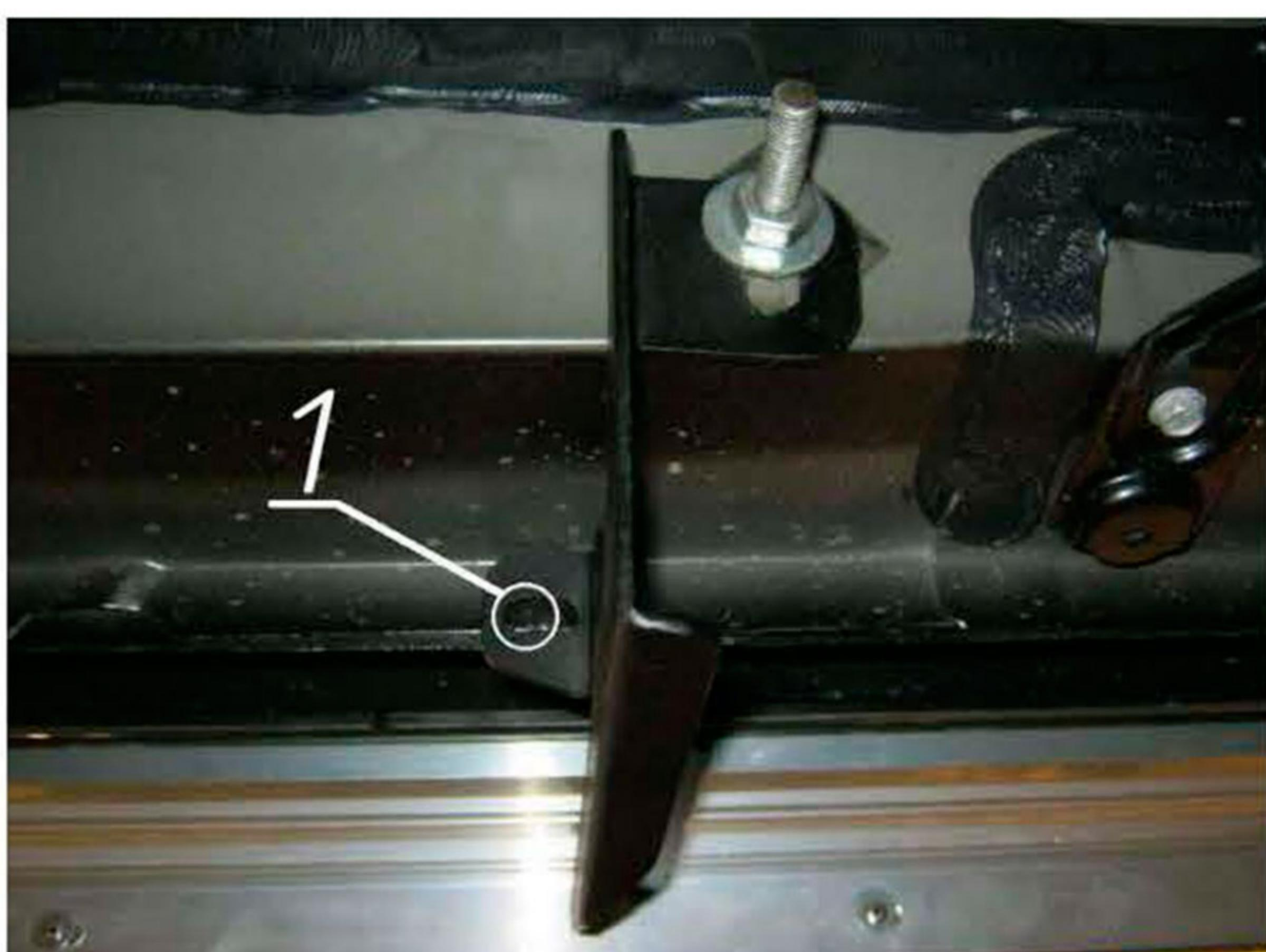
Рис.4 Установка переднего кронштейна
