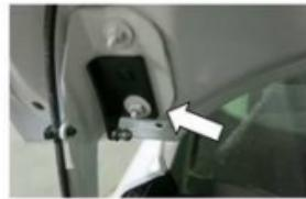
2. Открутить нижнюю гайку крепления капота. Установить кронштейн капота как показано на рисунке, попав штифтом в технологическое отверстие. Затянуть гайку ключом №10 с усилием 9 Нм.
