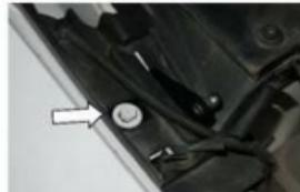
1. Открутить болт крепления крыла. Установить кронштейн крыла, как показано на рисунке. Затянуть болт ключом №10 с усилием 9 Нм.
