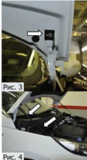
3. Открутить верхний болт крепления капота. Установить кронштейн капота, уперев его в ребро жесткости. Затянуть болт M8x20 с шайбой ключом №13 с усилием 23 Нм (рис.3).
