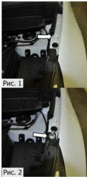
1. Открутить штатный болт крепления крыла торцевой головкой №10 (рис.1).
