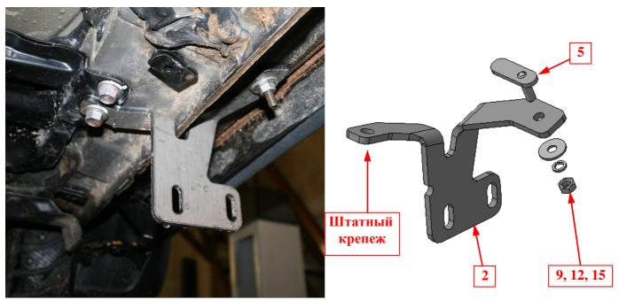
**Шаг 2** Установить закладные поз.5 в отверстия в передней части днища автомобиля (справа и слева). Установить на закладные кронштейны поз.2, закрепить крепежом поз.9, 12 и 15 и штатным.
