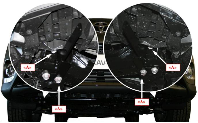
**Шаг 2** Отвернуть штатные болты «А» согласно рисунка. *Инструмент: Головка 19 с воротком.*
