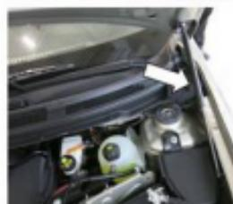
2. Установить кронштейн крыла, как показано на рисунке. Плотно прижать подгиб кронштейна к кузову и затянуть болт и гайку ключом №13 с усилием 23 Нм.
