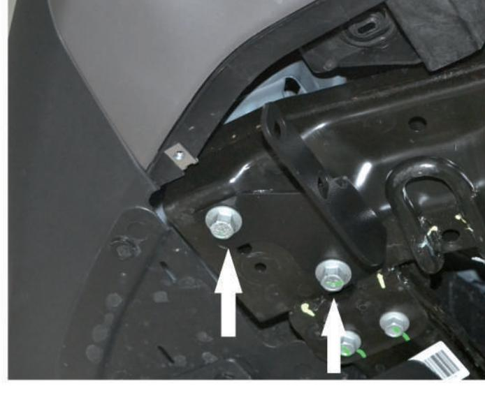
Рис. 2 - Установка кронштейнов
