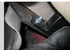
**ШАГ 4.** Установите кронштейн розетки и закрепите его на шпильке с помощью гайки М10 через шайбу 10 увеличенную и шайбу 10 пружинную. Установите съемный шар в сборе и закрепите его пальцем гнутым со шплинтом.
