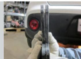
**ШАГ 2.** Для установки кронштейна бокового, отыщите два отверстия с закладными гайками в заднем лонжероне автомобиля. Прикрутите кронштейн к внешней, боковой стороне лонжерона с помощью болтов М10х40х1,25, через шайбы 10 и шайбы пружинные 10. На другой стороне автомобиля кронштейн боковой устанавливается аналогично. Соединения не затягивайте
