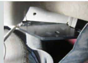
**ШАГ 3.** Установите кронштейн центральный, совместив отверстия в кронштейнах боковых и центральном. Закрепите кронштейн с помощью болтов М10х40х1,25, гайками М10х1,25 через шайбы 10 и шайбы пружинные 10. Отрегулируйте положение центрального кронштейна относительно бампера и затяните все соединения.
