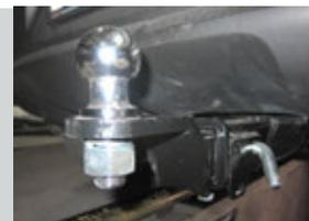
Тип шара «Е»; Тип соединения: шаровый; Диаметр сцепного шара: 50 мм.; Масса комплекта ТСУ 06081501: 16,7 кг.
