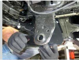
**ШАГ 3.** Закрепите закладную пластину на буксирной проушине с помощью двух болтов M10x40x1,25 через шайбы и гроверы на 10 как показано на фото.
