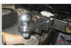
Тип шара «Е»; Тип соединения: шаровый; Диаметр сцепного шара: 50 мм.; Масса комплекта ТСУ HVH991101: 24,0 кг.
