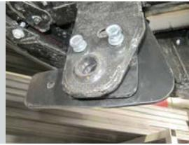
**ШАГ 4.** Установите центральный кронштейн совместив отверстия в центрального кронштейна с отверстиями боковых кронштейнов и соедините их с помощью болтов M12x45x1,25 через шайбы на 12 и гроверы на 12, гайками M12x1,25.
