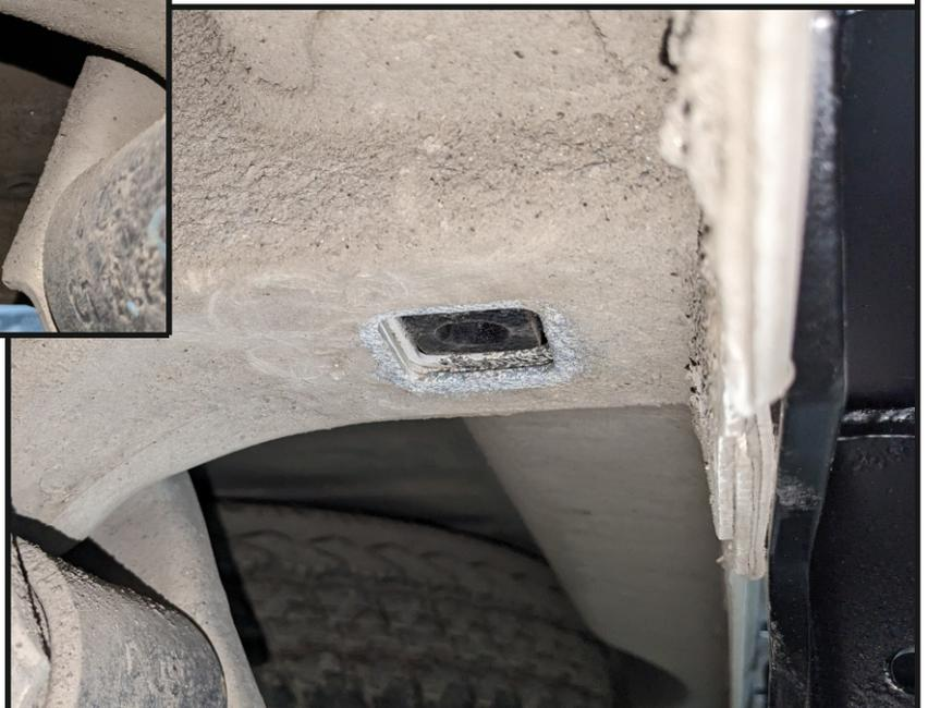
**Установить закладную М10х1,25 (10) в отверстие лонжерона автомобиля. С другой стороны аналогично.**
