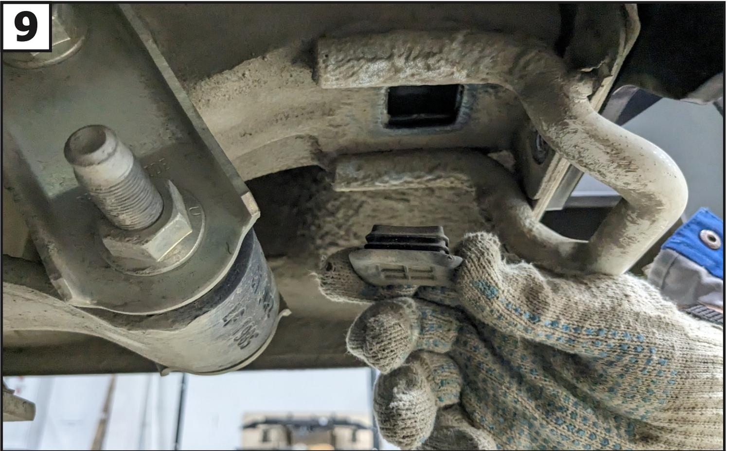
**Снять заглушки с лонжеронов автомобиля.**
