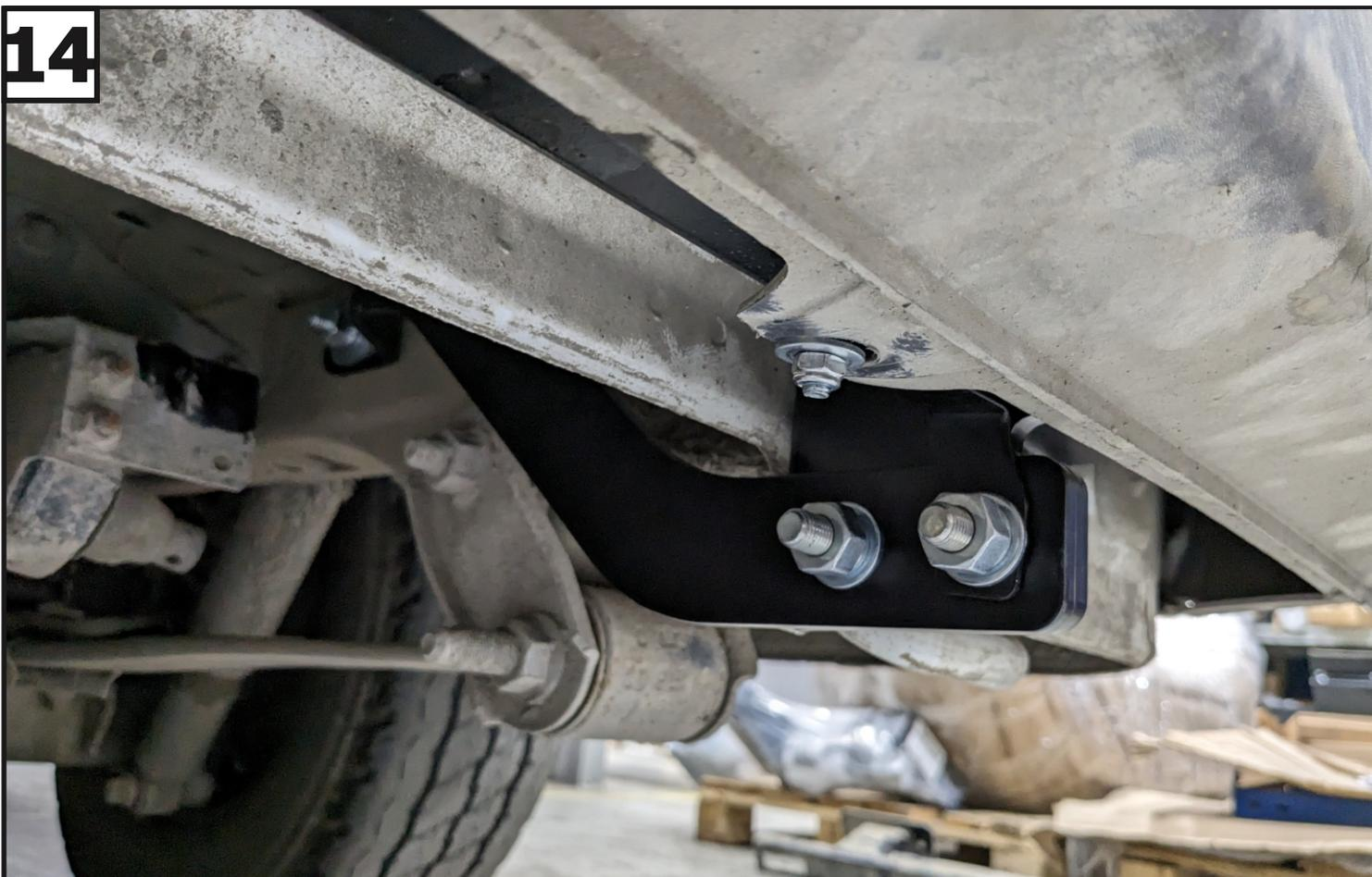
**Установить бампер в обратной последовательности, закрепив его к креплениям бампера (6 и 7) при помощи болтов М6х16 (11), шайб 6 (21) и шайб 6 увел. (22).**
