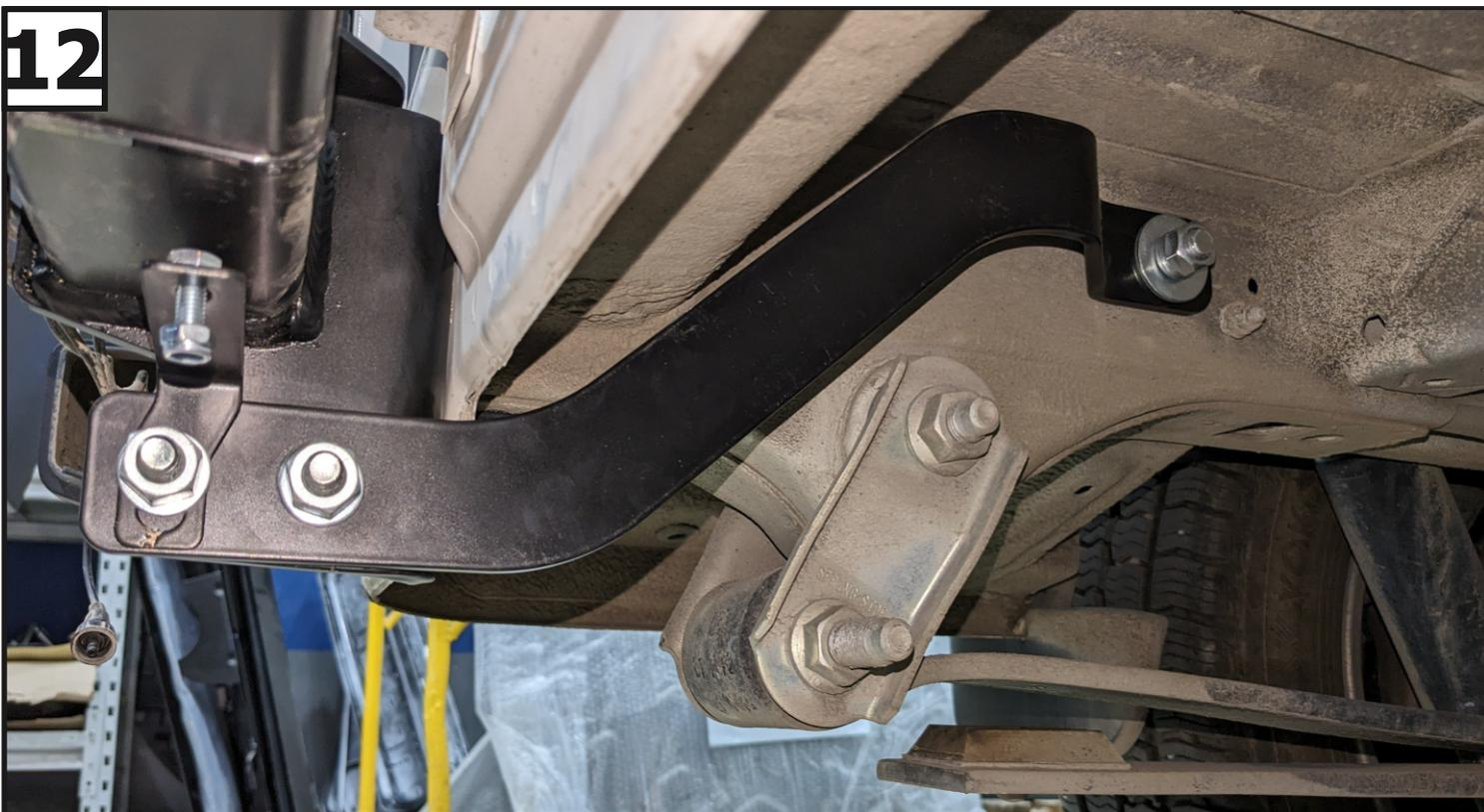
Установить левый кронштейн лонжерона (2) совместно с левым креплением бампера (6), закрепив его к лонжерону автомобиля и балке ТСУ (1) при помощи болта M12x130 (15), шайбы 12 пружинной (26), шайб 12 увел. (27), гаек M12 (19), болтов M10x1,25x40 (13), шайб 10 пружинных (24), шайб 10 (23) и гаек M10x1,25 (18). Правый кронштейн лонжерона (3) и правое крепление бампера (7) устанавливаются аналогично.
