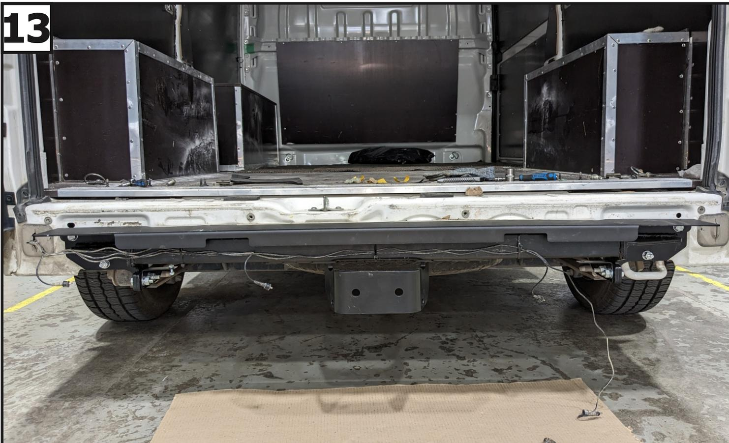
**Закрепить проводку датчиков парковки к балке ТСУ. Отрегулировать положение ТСУ относительно центра автомобиля и затянуть все резьбовые соединения. Моменты затяжки: М6=10 Нм, М10=47 Нм, М12=81 Нм.**
