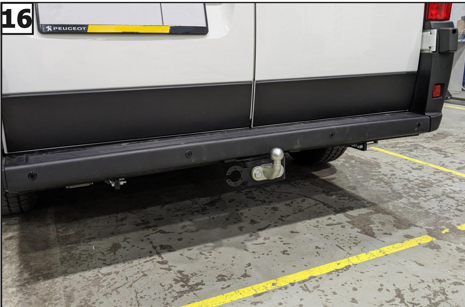
Затянуть все резьбовые соединения. Моменты затяжки: М16=200 Нм.
