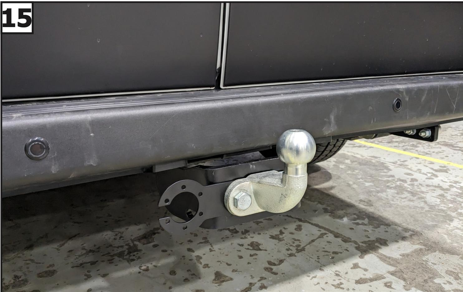
Установить кронштейн под розетку (5) и крюк (9) с помощью болтов М16х50 (16), шайб 16 (28) и гаек М16 (20).
