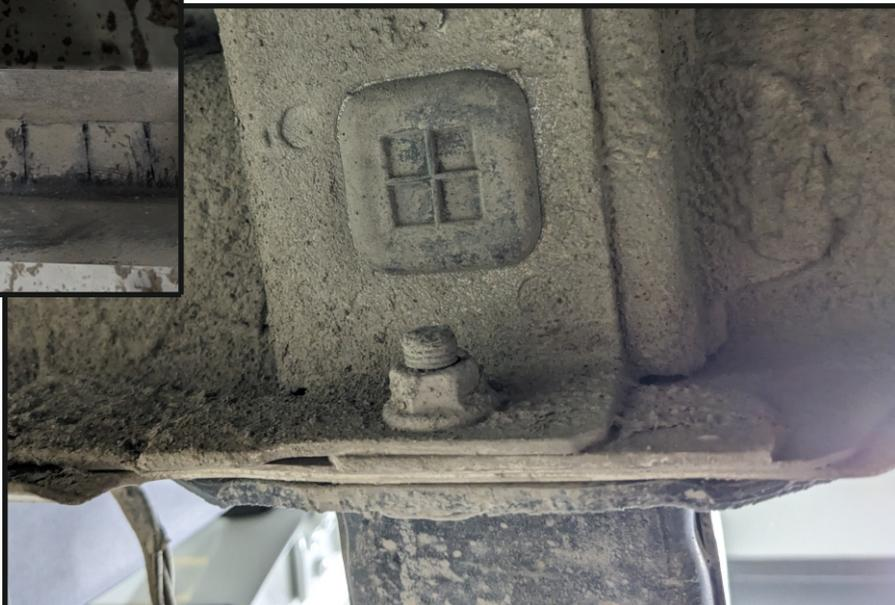
**Открутить болты и гайки крепления усилителя бампера с обеих сторон автомобиля и демонтировать усилитель (в дальнейшем не используется).**
