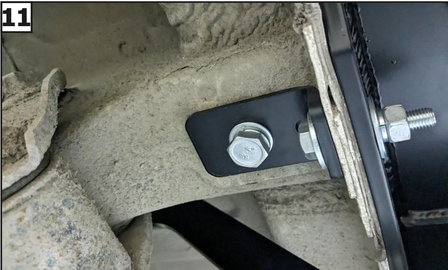
Установить уголок (4), закрепив его к закладной M10x1,25 (10) и балке ТСУ (1) при помощи болта M10x1,25x40 (13), болта M10x1,25x50 (14), шайб 10 пружинных (24), шайб 10 увел. (25) и гаек M10x1,25 (18). С другой стороны аналогично.
