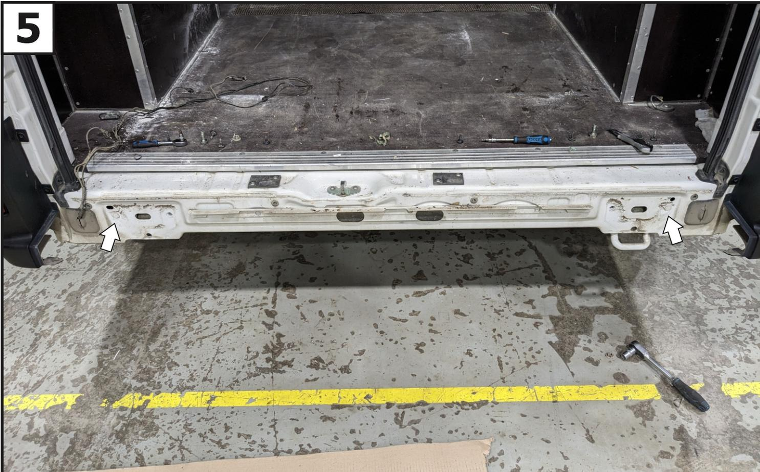
**Отклеить наклейки с задней панели автомобиля.**
